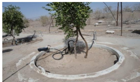
شکل ۱- نمای یکی از لایسیمترهای مورد استفاده در اعمال تیمارهای کم آبیاری در عناب. استفاده از تی-دی-آر برای اندازه‌گیری رطوبت خاک را نیز نشان می‌دهد.
